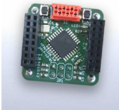
Fig. 1: fertige MMC 1x1 328PB Platine
