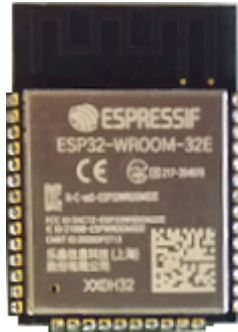
Fig. 3: Ausgewähltes Modul ESP32-WROOM-32E
