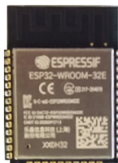
Fig. 3: Ausgewähltes Modul ESP32-WROOM-32E
