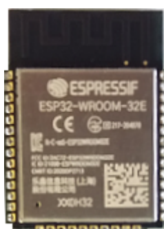
Fig. 3: Ausgewähltes Modul ESP32-WROOM-32E
